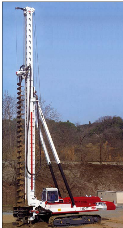
Fot. 4. Palownice do pali wierconych świdrem ciągłym „CFA”
