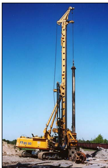
Fot. 3. Wiertnica „BAUER” do wykonywania pali wierconych w rurach obsadowych.
