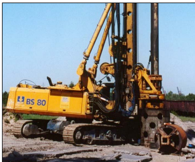
Fot. 3. Wiertnica „BAUER” do wykonywania pali wierconych w rurach obsadowych.
